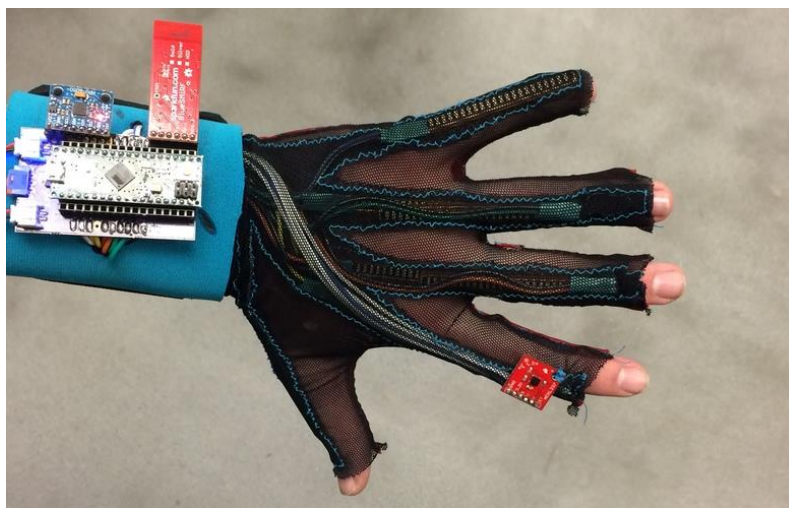
Rys. 3.10. SignAloud, prototyp rękawicy studentów z Uniwersytetu w Waszyngtonie (Perna, 2017)
