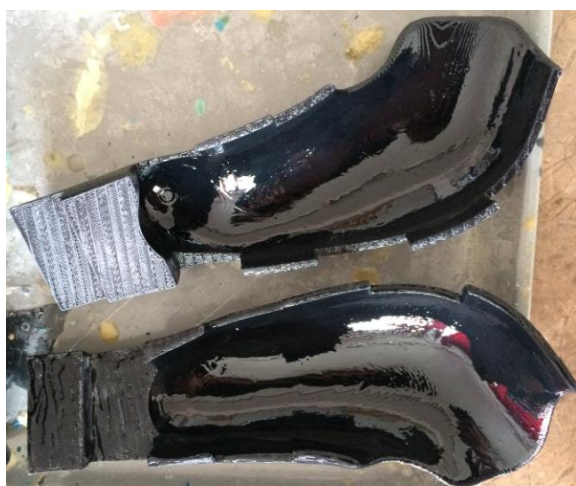
Rys. 8.31. Podwójna powłoka z żywicy epoksydowej po utwardzeniu
