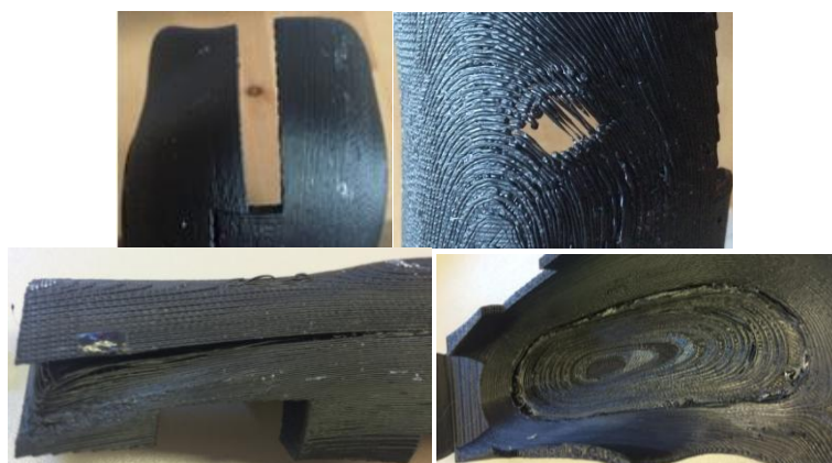
Rys. 8.25. Wady widoczne w modelu (MakerBot Replicator 2X)
