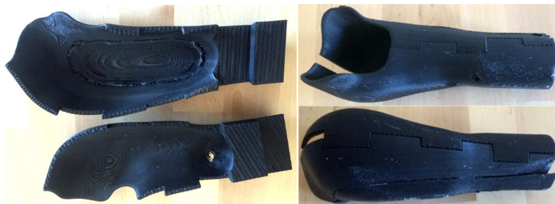
Rys. 8.24. Lej 1 wytworzony na urządzeniu MakerBot Replicator 2X
