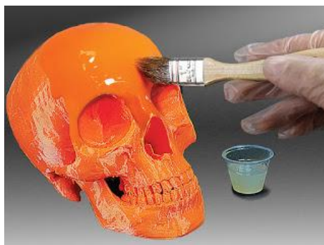
Rys. 5.14. Pokrycie produktu powłoką Smooth-on XTC [Smooth-On]
