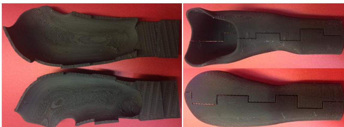
Rys. 8.26. Lej 1 wytworzony na urządzeniu Dimension BST 1200
