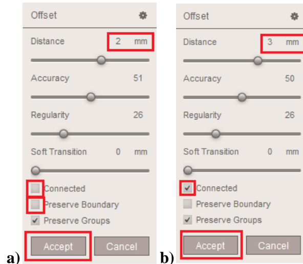
Rys. 7.31. Parametry: a) pierwszego, b) drugiego odsunięcia od płaszczyzny
