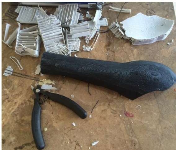
Rys. 8.22. Usuwanie podpory z modelu – Dimension BST 1200
