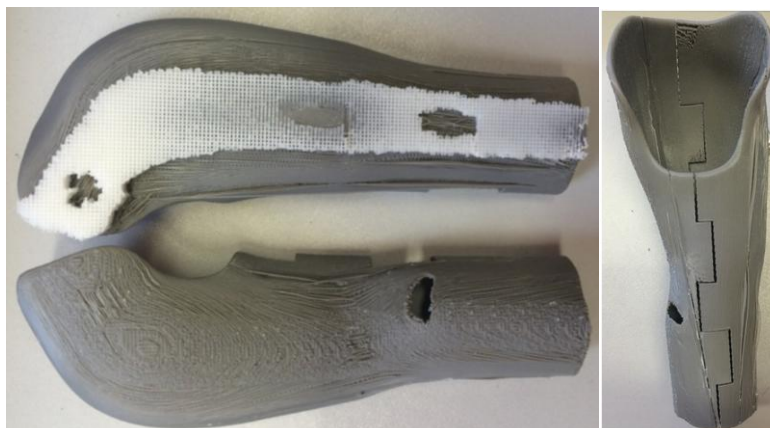
Rys. 8.7. Próbnny wydruk – otrzymane części i model po złożeniu
