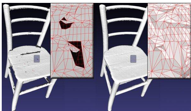
Rys. 3.6. Operacje naprawcze siatki [Microfabricator]
