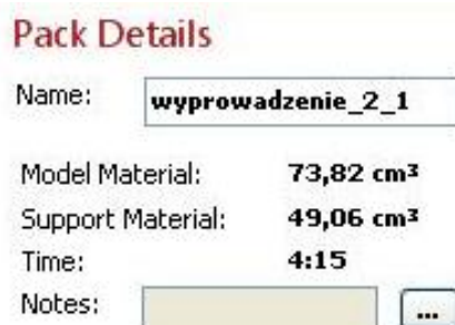
Rys. 8.12. Szacowane wartości zużycia materiału i czasu wytwarzania części leja 2
