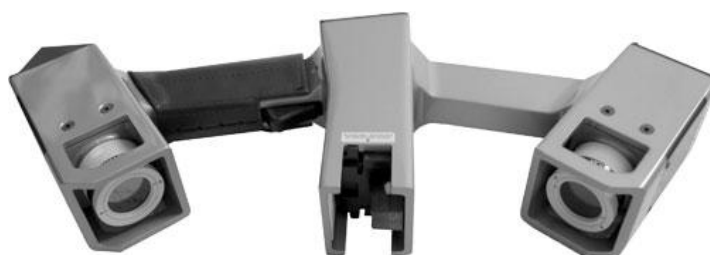
Rys. 3.17. BioScanner – urządzenie dedykowane pomiarowi ciała [BioSculptor]
