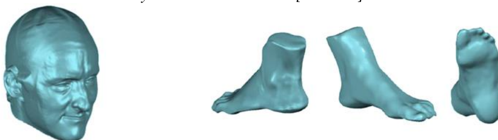
Rys. 3.15. Modele utrzymane skanerem Vialux [ViALUX]
