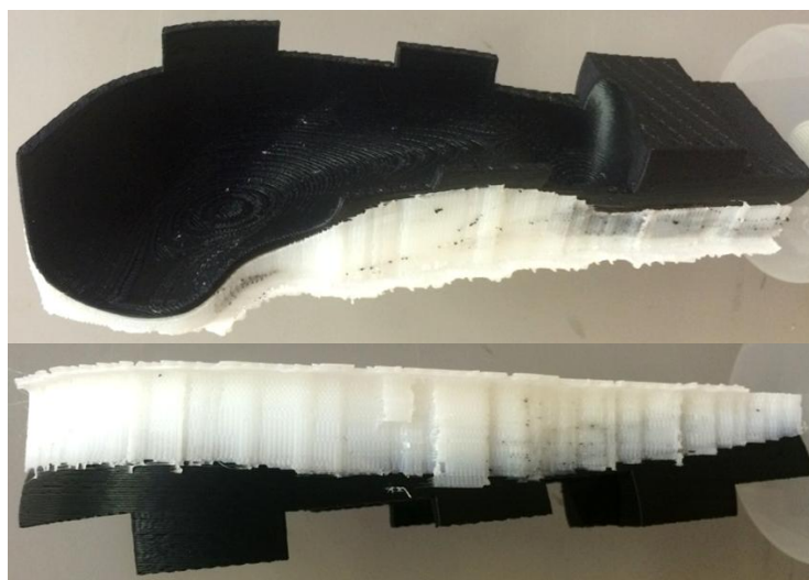
Rys. 8.19. Elementy leja 1 wraz ze strukturami pomocniczymi wytworzone na urządzeniu MakerBot Replicator 2X
