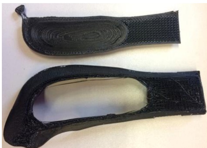
Rys. 8.23. Pęknięty model – MakerBot Replicator 2X
