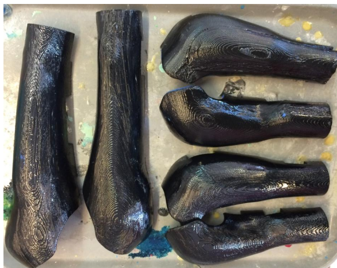
Rys. 8.34. Zewnętrzne powierzchnie wyprowadzeń pokryte żywicą epoksydową
