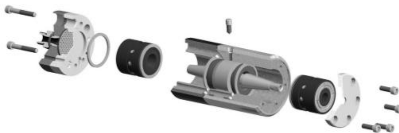
Rys. 4.5. Widok montażowy zespołu elektrowrzeciona [Pawłowski, Mosion 2012]
