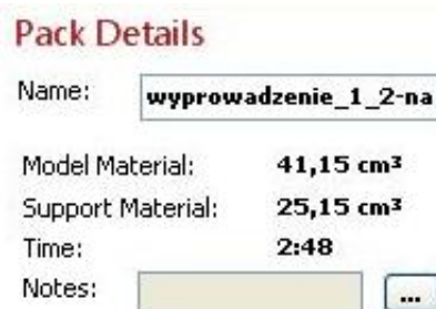
Rys. 8.11. Szacowane wartości zużycia materiału i czasu wytwarzania części leja 1
