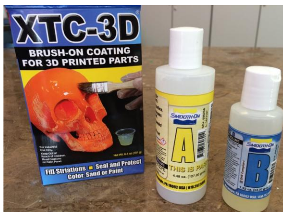
Rys. 8.30. Składowe preparatu XTC-3D
