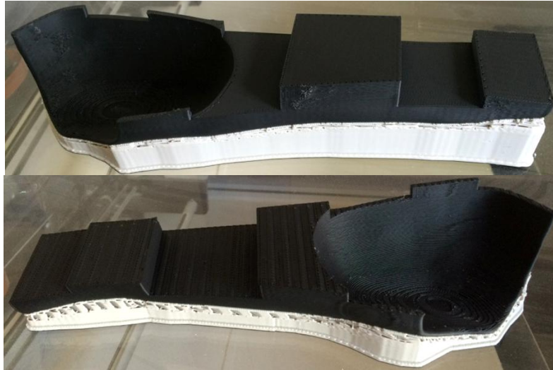
Rys. 8.20. Elementy leja 2 wraz ze strukturami pomocniczymi wytworzone na urządzeniu Dimension BST 1200
